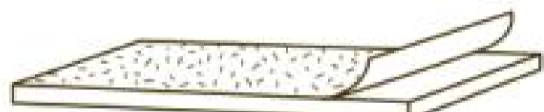
MDF ou Panneau de particules + décor sur flax MDF or chipboard + decor on flax
